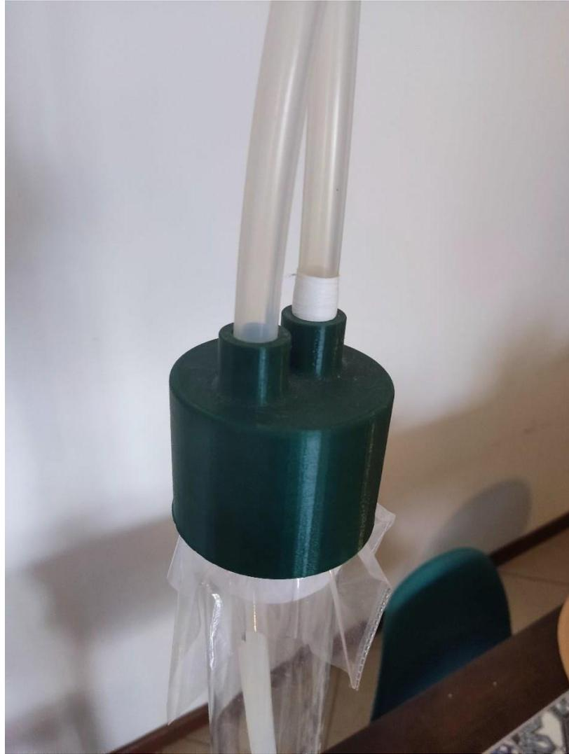
*Figura 31 - Protótipo funcional - Fotografia da Tampa(Válvula)*
