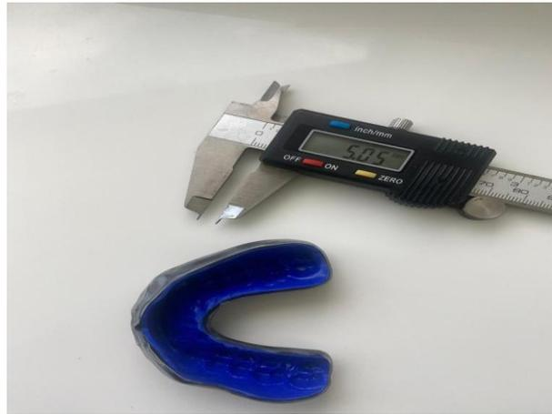
**Figura 5:** Protetor bucal com espessura aproximada de 5mm.
