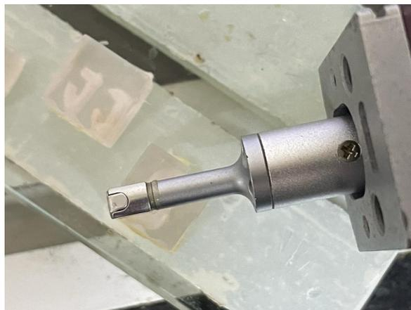
Figura 3- Leitura da rugosidade superficial dos corpos de prova.
