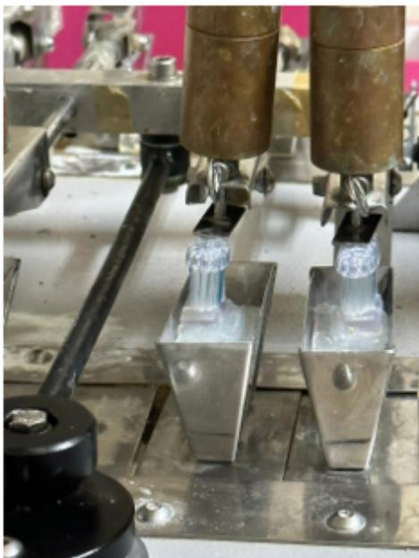
Figura 4- Corpos de prova posicionados para serem submetidos à escovação simulada.
