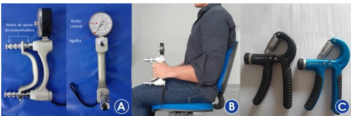
Figura 1. Dinamômetro Jamar® (A), posicionamento do voluntário (B) e o aparelho de handgrip utilizado durante o protocolo na esteira (C).
