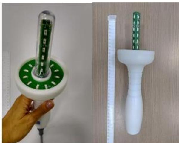
**Figura 2** Fonte de emissão do LED com e sem o dispositivo plástico descartável de proteção
