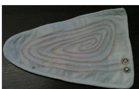
Figura 2: Vista externa do sensor de umidade.
