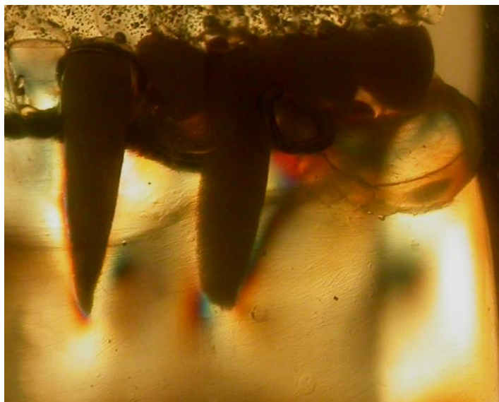
Figura 2 – Corpo de prova com dois pânticos sob a aplicação de 2,5 bar.
