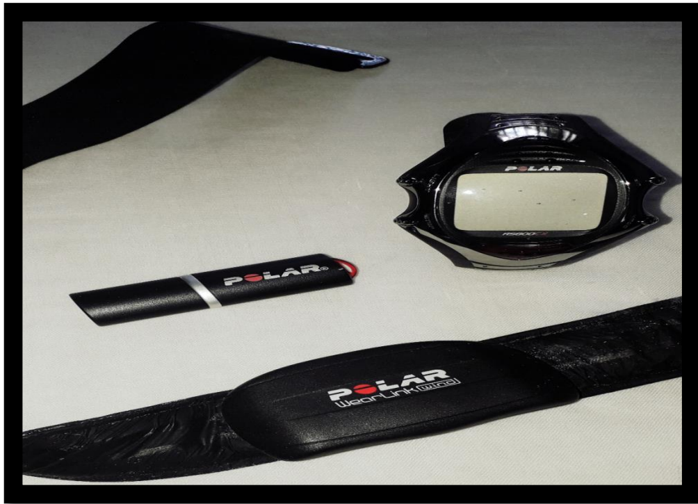
Figura 5 - Frequencímetro Polar RS800CX® no canto superior direito, monitor de conexão infravermelho – Infrared Data Association (IrDA) Polar®, do lado esquerdo e cinta elástica Polar® na parte inferior Fonte: próprio autor.
