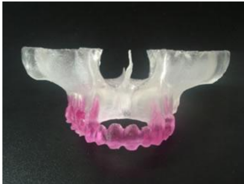
FIGURA 20 - Modelo de prototipagem produzido por Estereolitografia
