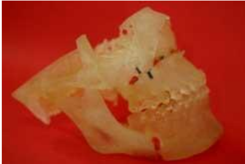
FIGURA 19 - Modelo de prototipagem produzido por Estereolitografia
