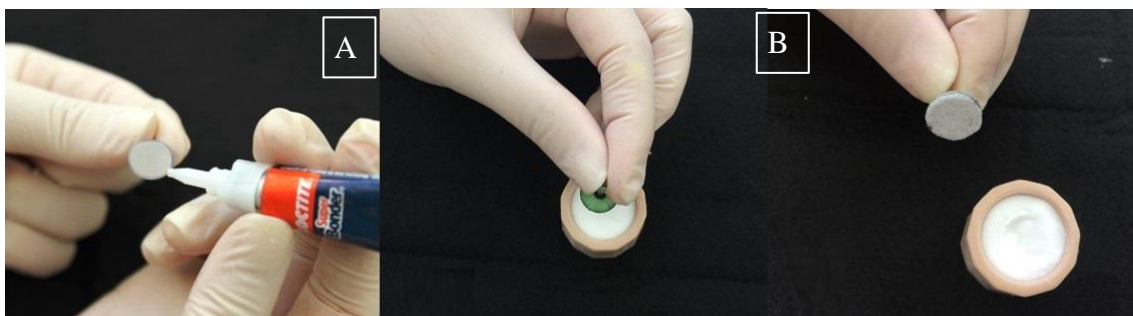
Figura 3: Selamento das Amostras: (A) Aplicação do adesivo ; (B) Incorporação do polímero; (C) Selamento concluído.
