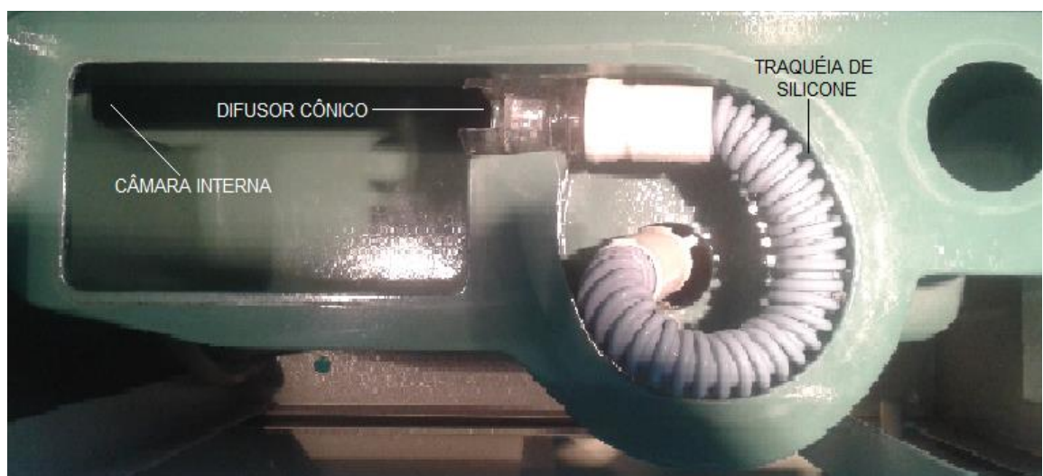
Figura 17: Câmara com traquéia de silicone e difusor usados para a condução do ar. Fonte: O próprio autor
