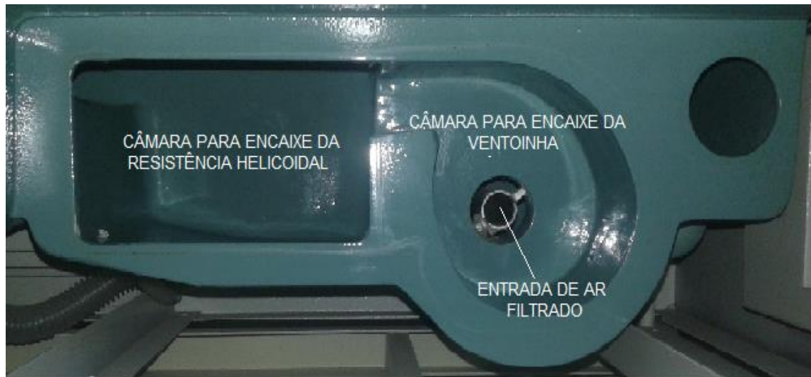
Figura 16: Câmara para conexão da Unidade Controladora Microprocessada-UCM. Fonte: O próprio autor
