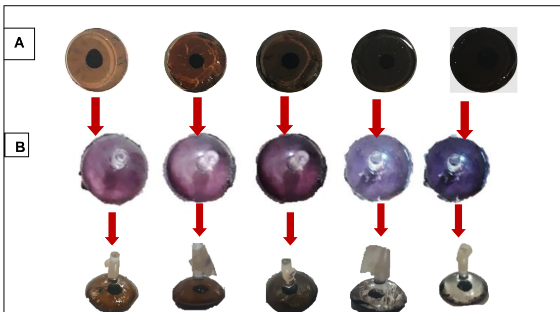
Fig. 6: A) amostras antes do tratamento; B) Amostras impressas alteradas após submetidas a envelhecimento acelerado; C) Amostras pintadas alteradas após submetidas a envelhecimento acelerado.
