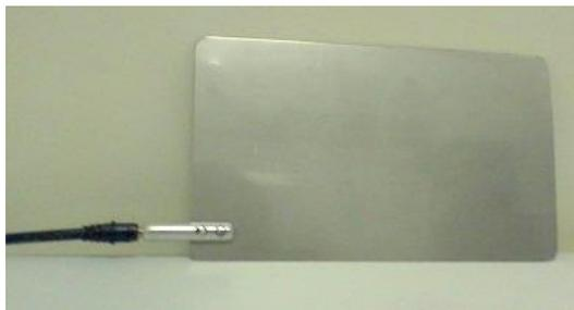
**Ilustração 3.** Eletrodo de acoplamento do aparelho de radiofrequência
