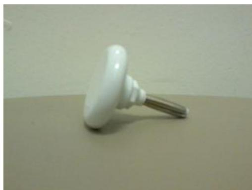
**Ilustração 2.** Manopla (eletrodo ativo) do aparelho de radiofrequência
