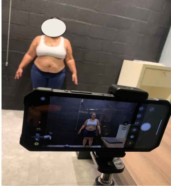
Figura 20. Posicionamento do voluntário da pesquisa e da câmera para a captura de imagem para fotogrametria
