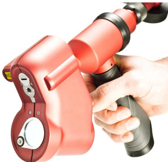
Figura 2 – Escâner SCANFLEX – API/BACES® (Automated Precision Inc, Maryland, Estados Unidos) Fonte: Fabricante
