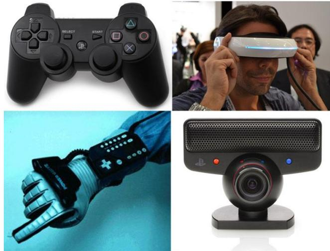
Figura 2: Joystick, HMD, luvas de force-feedback( powerglover), cameras especiais, respectivamente.
